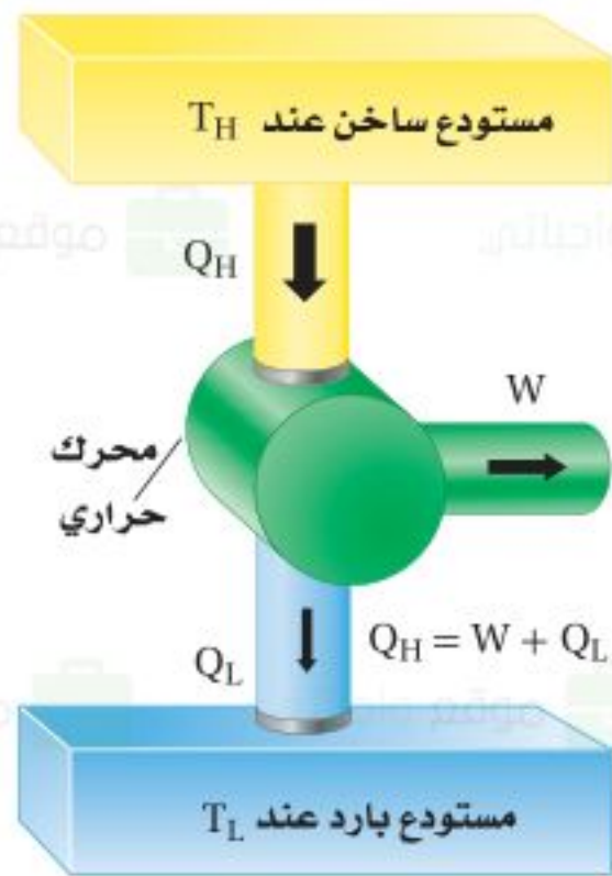
■ الشكل 6-11 محرك حراري يحول الحرارة عند درجة الحرارة المرتفعة إلى طاقة ميكانيكية وإلى حرارة ضائعة عند درجة حرارة منخفضة.
